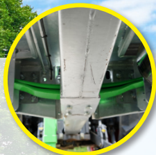
Suspensión de la lanza por láminas parabólicas
