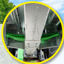
Deichselfederung durch Querblattfedern
