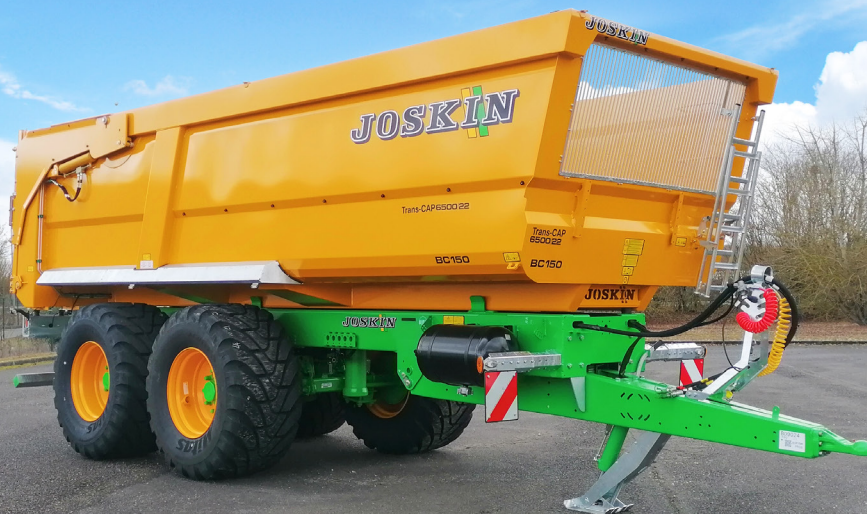
Roll-Over vering om de tractie in moeilijke omstandigheden te vergemakkelijken
