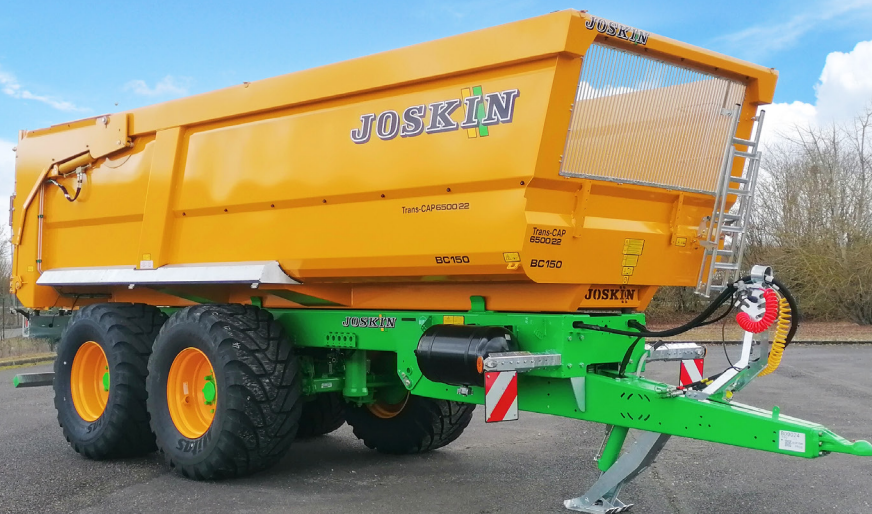
Suspension Roll-Over pour faciliter la traction en conditions difficiles
