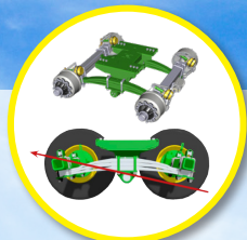
Suspension Roll-Over pour faciliter la traction en conditions difficiles
