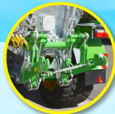
Elevador integrado y equipamiento hidráulico «Automata 2+4»
