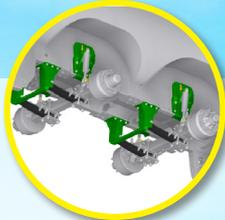
Verschraubtes und verstellbares Hydro-Tandem
