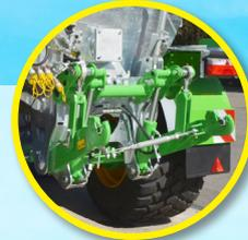
Integriertes Hubwerk und hydraulische Ausstattung „Automat 2+4“
