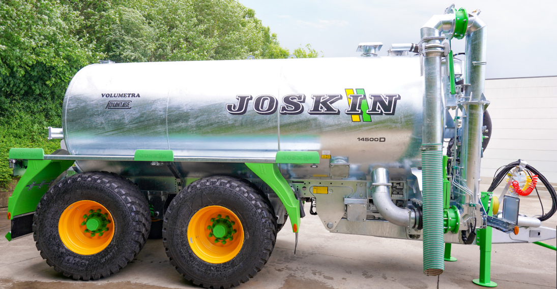
Gedwongen stuuras en Hydro-Tandem hydraulische vering
