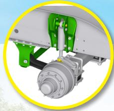
Zwangslenkachse und hydraulische Federung Hydro-Tandem
