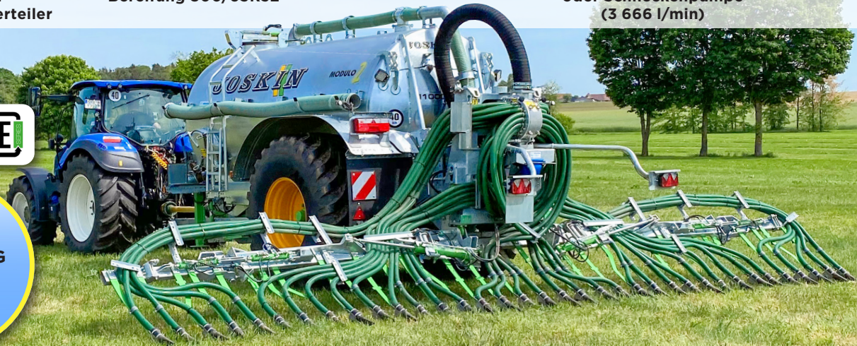
Radkasteneinbau: Bereifung 800/65R32
