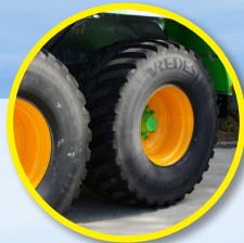
Колеса 750/60R30.5 Vredestein Flotation Trac
