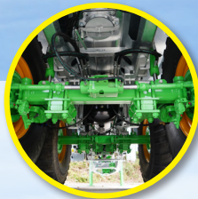
Ходовая часть с гидравлической подвеской
