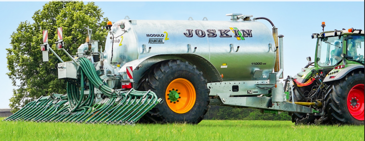
Pompe 11 000 l/min • Ecopump • Soupape Ø 150 mm
