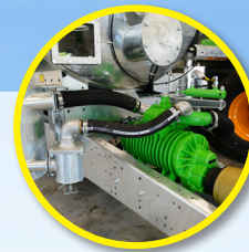
Pompe 11 000 l/min • Ecopump • Soupape Ø 150 mm
