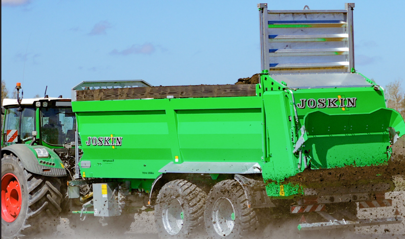
2 horizontale Fräsrollen mit Streuteller (2 x Ø 1 040 mm)
