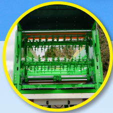
2 horizontale Fräsrollen mit Streuteller (2 x Ø 1 040 mm)
