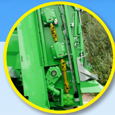
Antrieb über Getriebe und Kardanwelle
