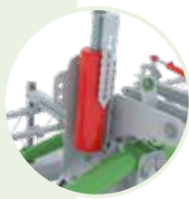
Variflex: bezstopniowa regulacja nacisku zębów ustawianych hydraulicznie za pomocą większej liczby siłowników kompensacyjnych i jednego lub dwóch siłowników centralnych z podziałką .
