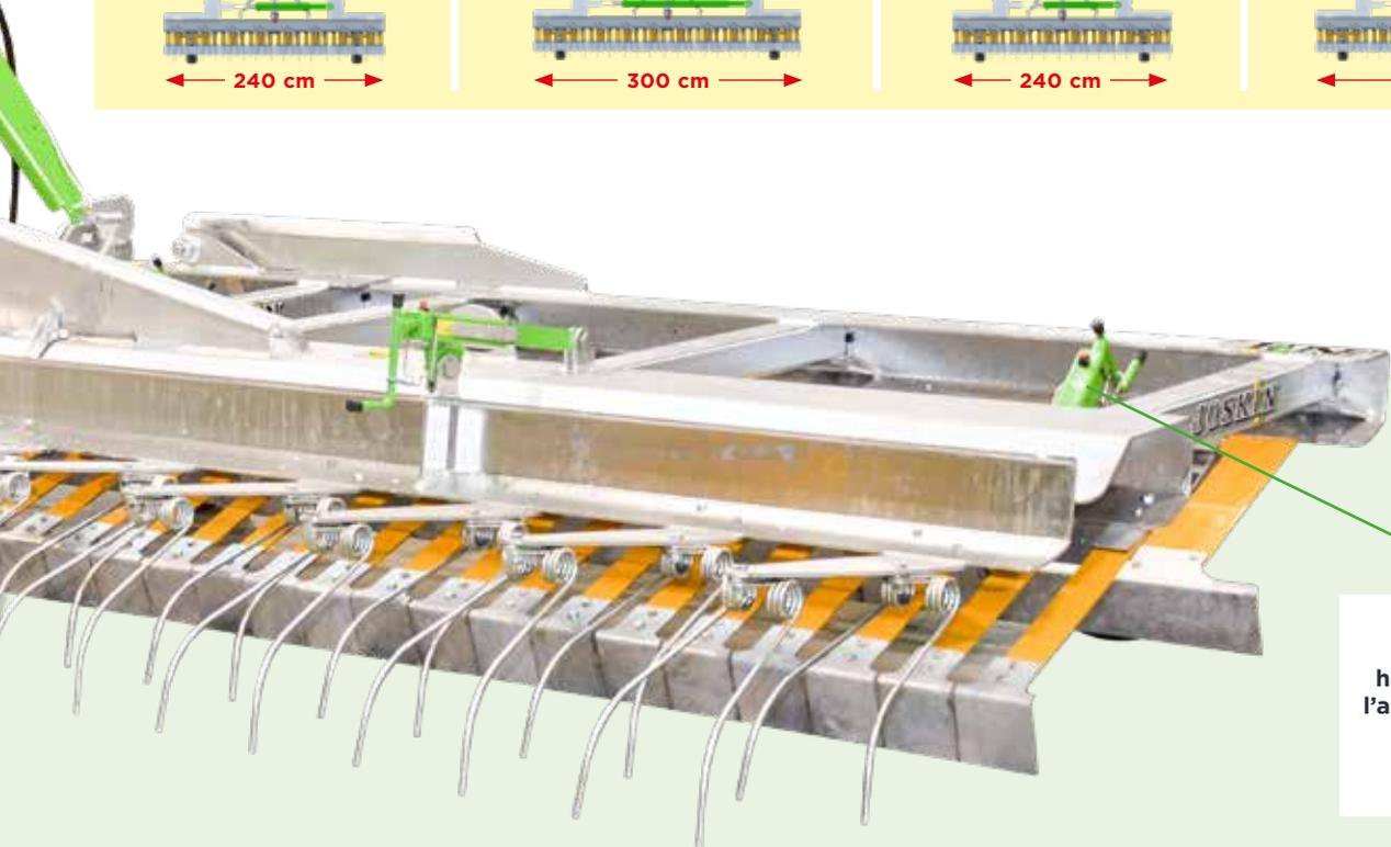
Réglage de la hauteur des roues à l'aide d'une manivelle avec graduation de repérage
