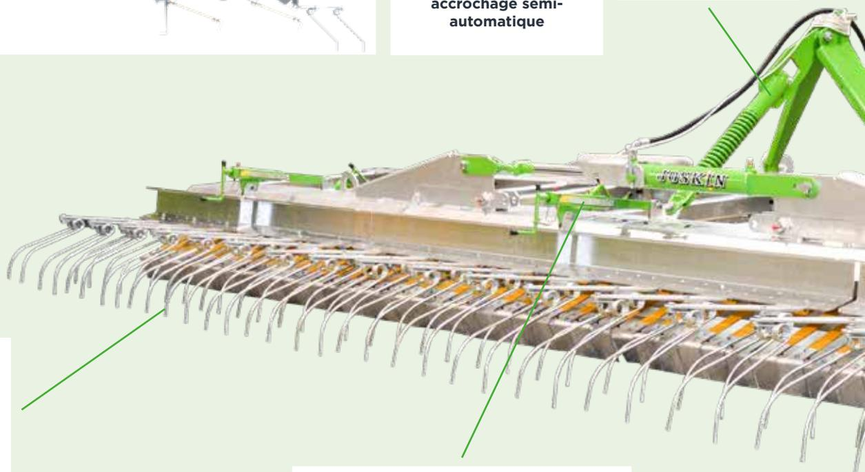
Réglage manuel des 2 rangs scarificateurs arrière à l'aide d'une manivelle avec graduation de repérage
