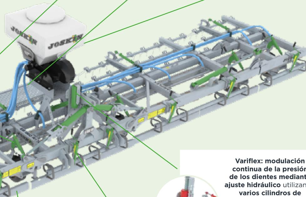
**Variflex: modulación continua de la presión de los dientes mediante ajuste hidráulico** utilizando varios cilindros de compensación y uno o dos cilindros centrales con marca graduada.
