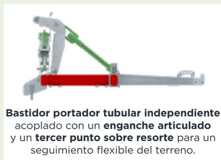
Bastidor portador tubular independiente acoplado con un **enganche articulado** y un **tercer punto sobre resorte** para un seguimiento flexible del terreno.
