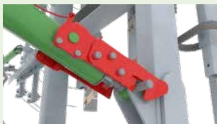
Bloqueo hidráulico y mecánico de las extensiones para una máxima seguridad en carretera.
