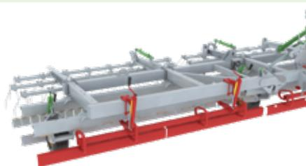
**Láminas de raspado independientes** de anchura variable (90 a 130 cm) según el modelo, situadas delante de las ruedas para nivelar el terreno.
