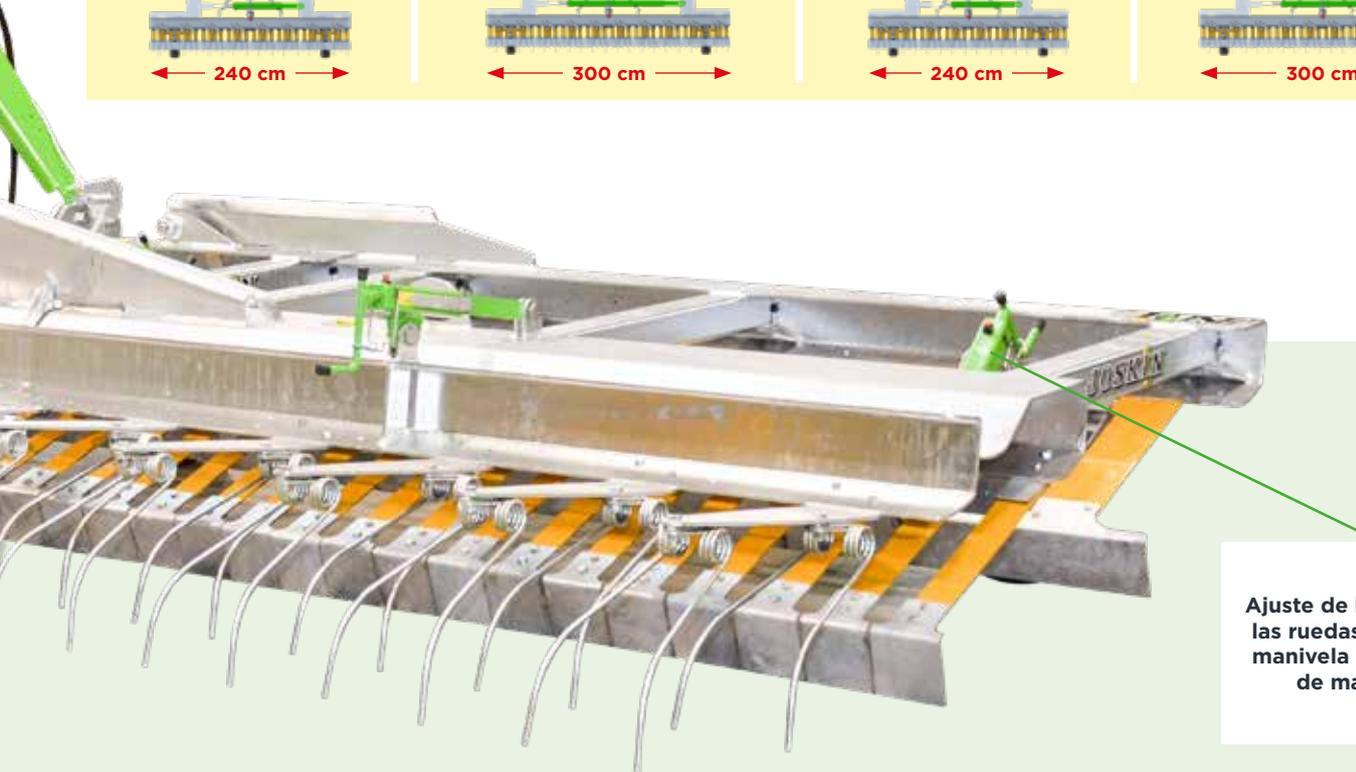
Ajuste de la altura de las ruedas mediante manivela con escala de marcado
