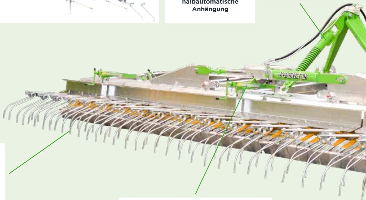
**Manuelle Einstellung der 2 hinteren Reihen Aufreißer mithilfe einer Kurbel mit Skala und Markierung**
