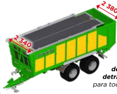
Caja cónica con anchuras interiores delante (2 340 mm) y detrás (2 380 mm) idénticas para todos los modelos.
