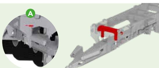
**Lanza con suspensión oleo-neumática** en los modelos Trídem (opcional en los Tándem).
