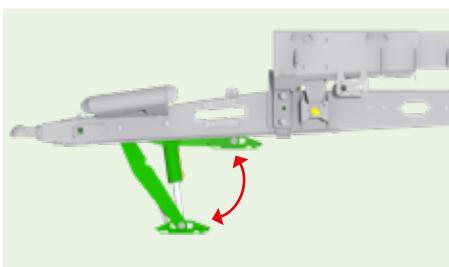
**Soporte hidráulico** con patín retráctil en el interior de la lanza con amplia base.
