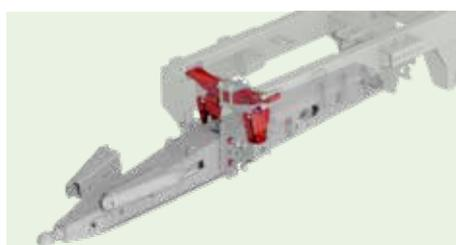
**Lanza con suspensión mecánica** (por láminas de resortes transversales) en los modelos Tándem.
